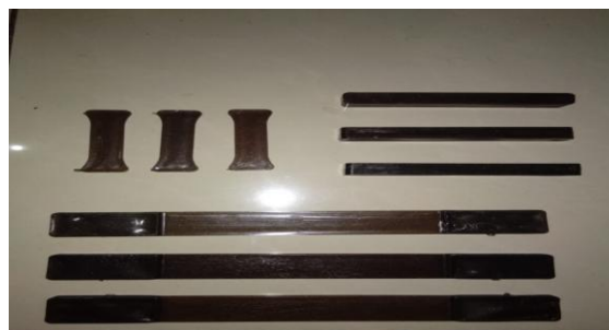
Gambar 8. Hasil Spesimen dengan Temperatur Barrel 250 °C
