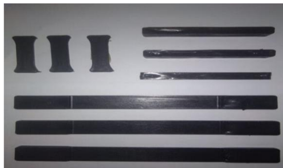
Gambar 11. Hasil Spesimen dengan Temperatur Barrel 280 °C
