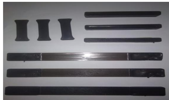
Gambar 10. Hasil Spesimen dengan Temperatur Barrel 270 °C
