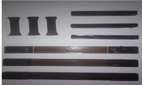
Gambar 9. Hasil Spesimen dengan Temperatur Barrel 260 °C
