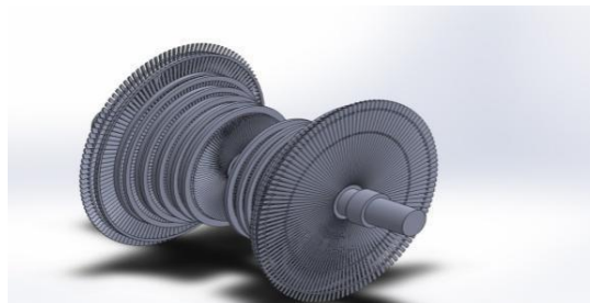
Gambar 4. Proses penggabungan antara shaft dan sudu gerak turbin
