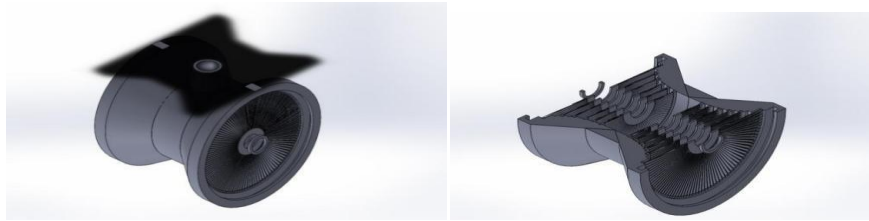
Gambar 5. Proses pembuatan rumah turbin
