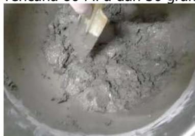
**Gambar 4. Campuran RPC setelah dilakukan penambahan air**
