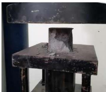
**Gambar 5. Pola keruntuhan pada beton**
