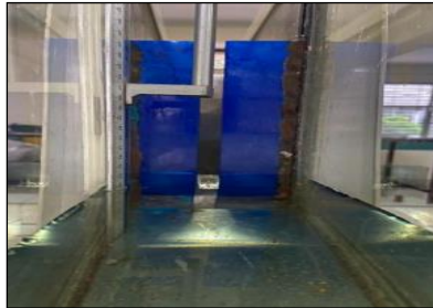
Gambar 3 Hasil Uji Laboratorium pada Ambang Tajam Persegi
