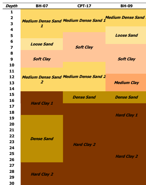
Gambar 1 Hasil Stratifikasi Tanah
