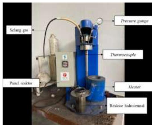
Gambar 1. Skema Rangkaian Alat
