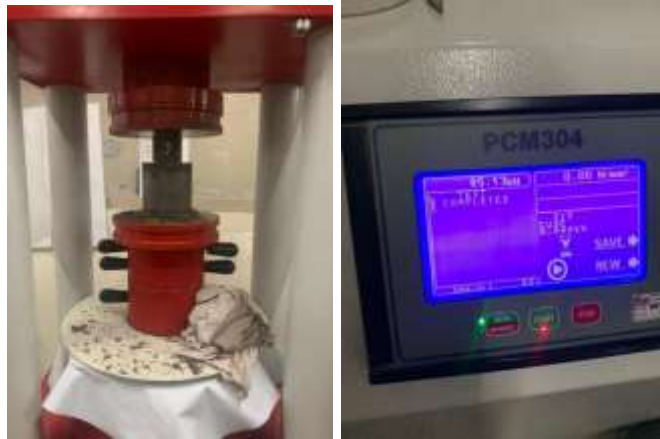
Gambar 1. Pengujian Kuat Tekan
