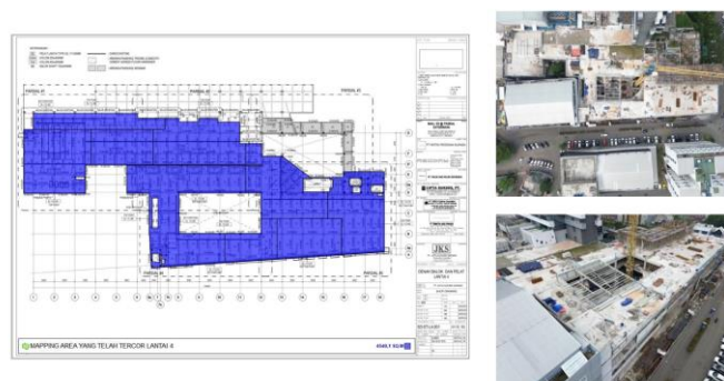
Gambar 7. Mapping Area Lantai 4 Yang Sudah Di cor
