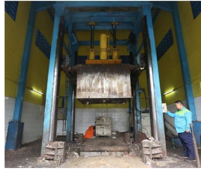
Gambar 4. Alat Pengolah Sampah Berupa Biodigester (Kiri) dan Mesin Press (Kanan) (Sumber: Hasil Observasi, 2020)
