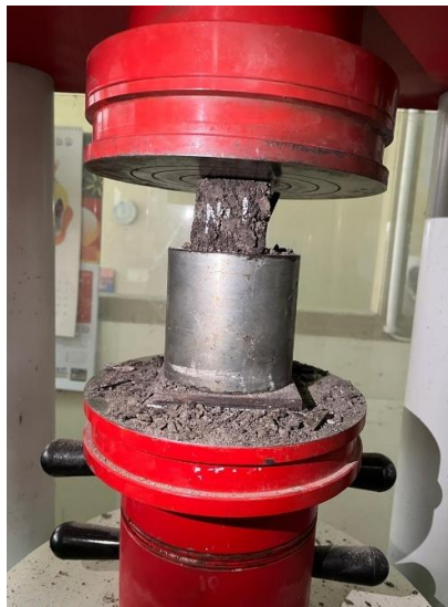
Gambar 2 Pengujian Kuat Tekan Menggunakan Compression Machine Test
