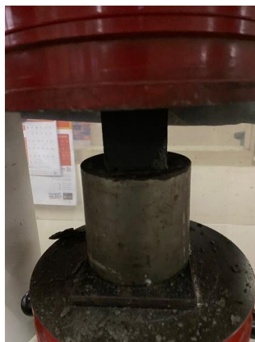
Gambar 2 Uji Kuat Tekan Mortar Geopolimer
