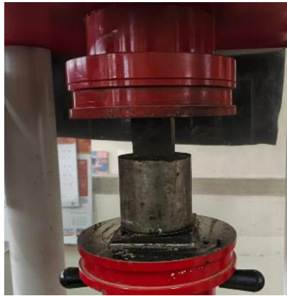
Gambar 2 Uji Kuat Tekan Mortar Geopolimer
