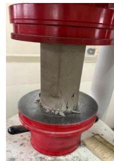
Gambar 4 Pengujian Kuat Tekan
