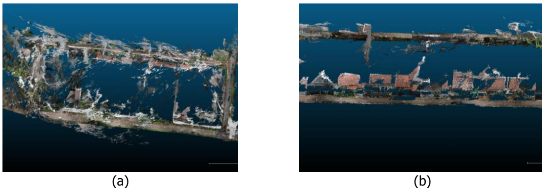
Gambar 3 Point Cloud TMMS Sebelum (a) dan Sesudah (b) Proses Filtering
