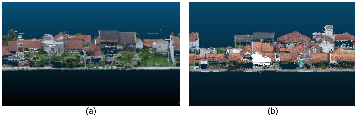
Gambar 2 Point Cloud Foto Udara Sebelum (a) dan Sesudah (b) Proses Filtering
