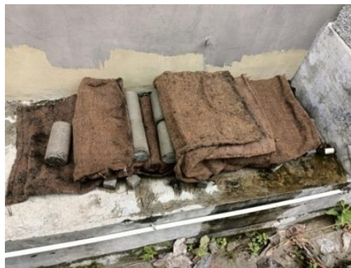
Gambar 1 Perawatan Benda Uji Dengan Dilapisi Karung Goni Basah
