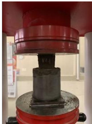
Gambar 1 Pengujian kuat tekan mortar menggunakan Compression machine
