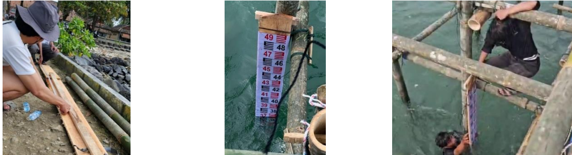
Gambar 2 Perangkat Alat Ukur Pasang Surut
