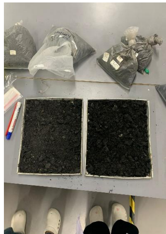
Gambar 2. Residu Padat Hasil Pirolisis ( Char )
