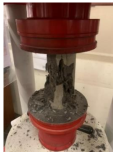
Gambar 2 Pengujian kuat tekan menggunakan Compression machine
