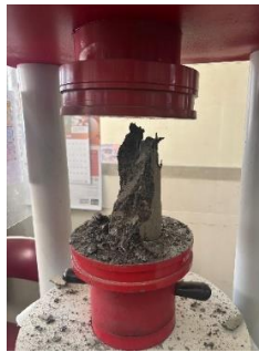
Gambar 1 Pengujian kuat tekan menggunakan Compression machine
