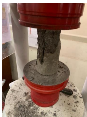
Gambar 4 Pengujian kuat tekan menggunakan compression machine
