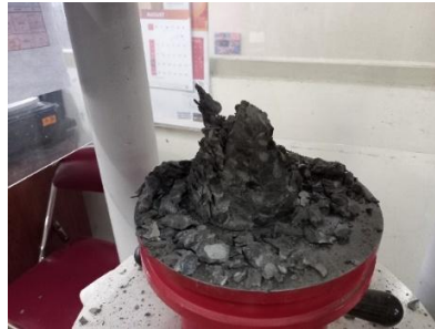
Gambar 3. Pengujian kuat tekan beton
