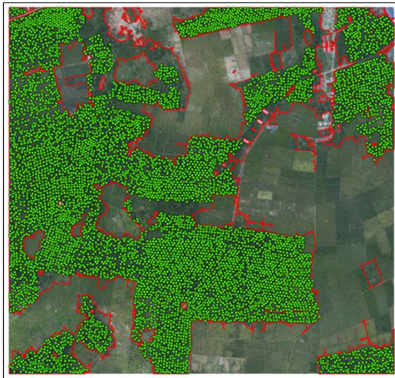
Gambar 3 Hasil Klasifikasi Objek Pohon Kelapa Sawit dengan Metode OBIA .
