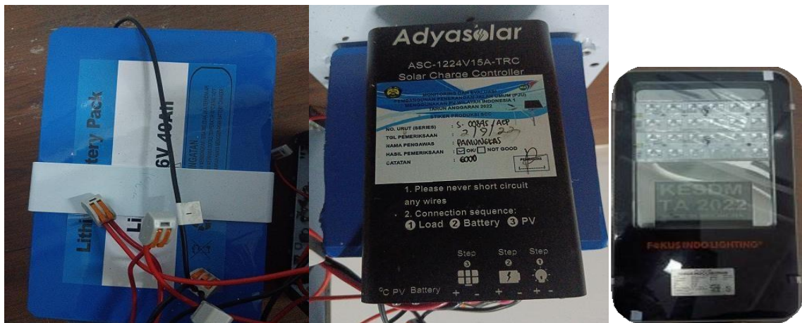
Gambar 3. Baterai 6V 40 (Ah), inverter dan lampu LED 50 W yang digunakan di Halaman Kantor Desa Lengkong.
