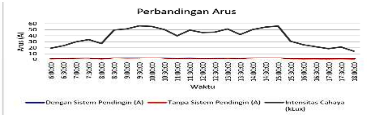
**Gambar 7. Perbandingan arus solar panel dengan sistem pendingin dan tanpa pendinginan**
