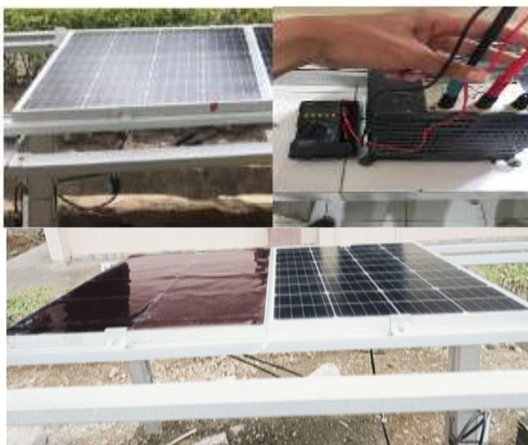
**Gambar 5. Pengukuran Output Panel dengan Pendingin**
