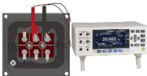
Gambar 2. Skema Pengukuran Resistansi Koil
