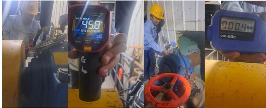
Gambar 4. Proses Pengukuran Getaran dan Suhu Induksi
