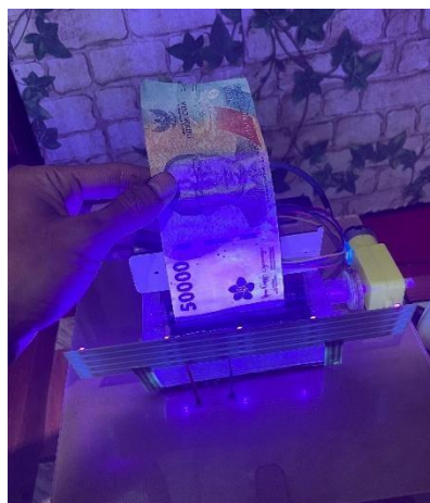
Gambar 5. Pengujian Sensor LTR390 Pada Uang Palsu dan Uang Asli
