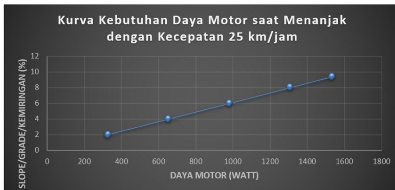
Gambar 4. Grafik Daya Penggerak Berdasarkan Slope/Grade/Kemiringan Jalan
