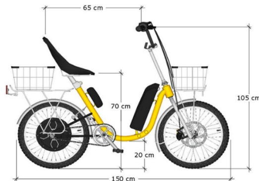
Gambar 7. Desain 3D sepeda listrik beserta ukuran nyata sepeda
