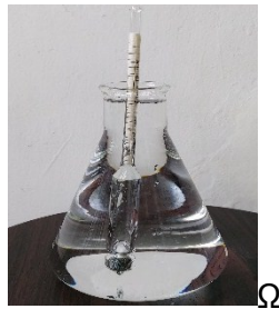
Gambar 1. Pengukuran kadar alkohol dalam hand sanitizer menggunakan alkohol meter
