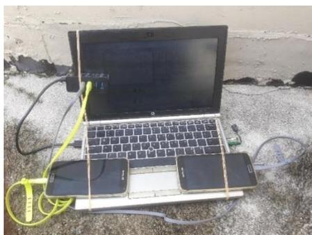
**Gambar 3. Peralatan *drive test indoor* yang sudah terpasang**
