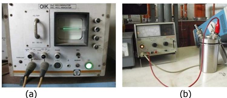
**Gambar 2. Pengujian Karakteristik dielektrik (a) tan delta meter dan null indikator (b) High Resistance Meter**
